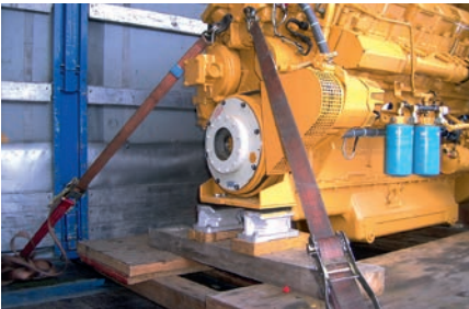
Bild 8.79: Sind Zurrpunkte an den Motoren vorhanden, können auch diese ohne Probleme gesichert werden.
