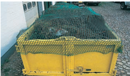
Bild 8.94: So gesichertes Schüttgut stellt keine Gefahr für andere Verkehrsteilnehmer dar. (Quelle: Dolezych)
