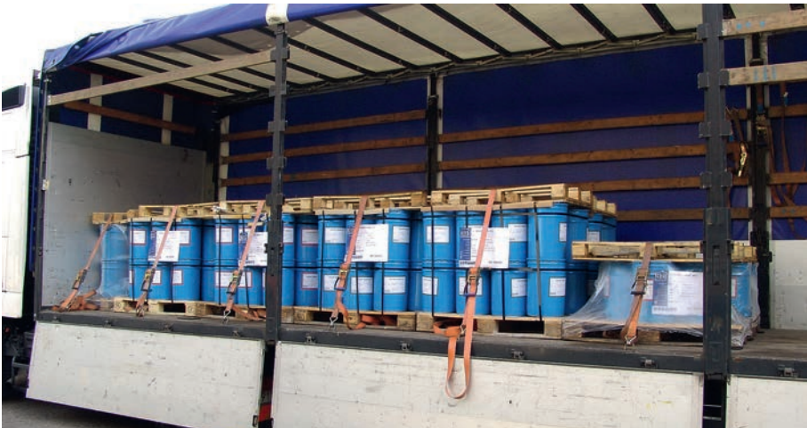
Bild 8.85: Der Einsatz von Paletten ist beim Niederzurren eine Möglichkeit, einen flächigen Anpressdruck zu erreichen.
