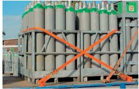
Bild 8.78: Der Transport von Gasflaschenpaletten erfolgt hier ohne Ladelücken und wurde formschlüssig nach vorn gesichert. (Quelle: Dolezych)
