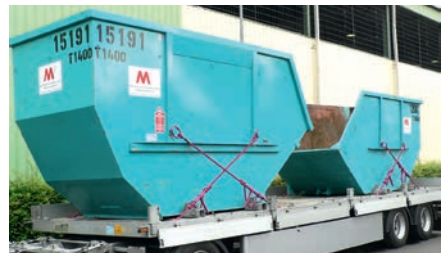
Bild 8.95: Schüttgutmulden können so auf Fahrzeugen gesichert werden.
