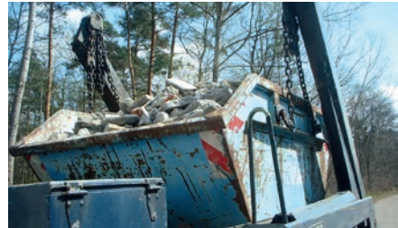
Bild 8.93: Hier ist der Einsatz eines stabilen Netzes zum Abdecken der Ladung erforderlich.
