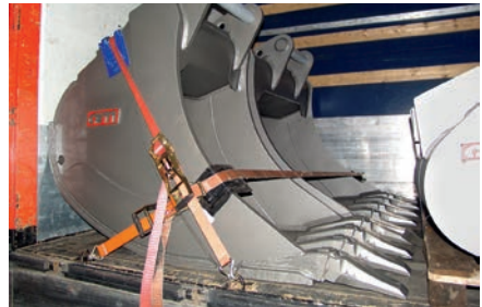
Bild 8.80: Baggerschaufeln formschlüssig zur Stirnwand und mit zwei Zurrurten als Kopflasche gesichert. Gute Lösung.
