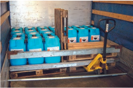
Bild 8.77: Dieser Säuretransport ist ohne Ladelücken und formschlüssig gesichert. Sogar der Gabelhubwagen ist mit einem Rundsperrbalken gesichert.
