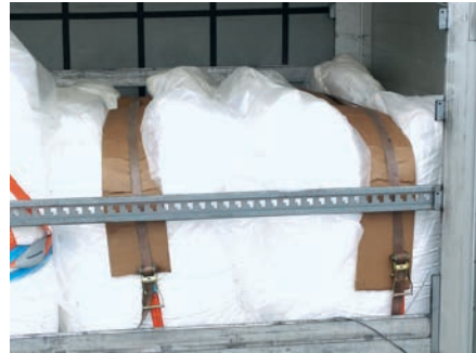
Bild 8.84: Palettierte Big Bags wurden niedergezurrt. Als Kantenschutz und zum Schutz der Bags dient hochfeste Pappe.
