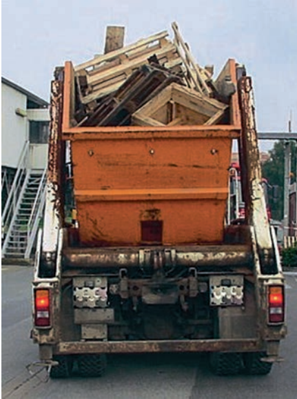
Bild 8.91: Die hoch herausragenden Bretter und Paletten müssen flach gelegt werden.
