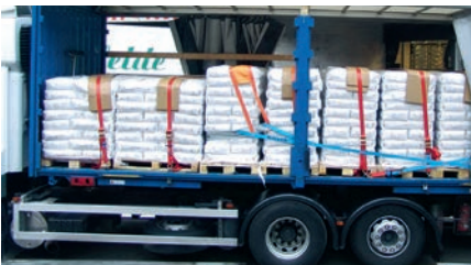
Bild 8.81: Palettierte Säcke wurden niedergezurrt. Als Kantenschutz und zum Schutz der Säcke dient hochfeste Pappe. Zusätzlich wurde mit Kopflasching gesichert.
