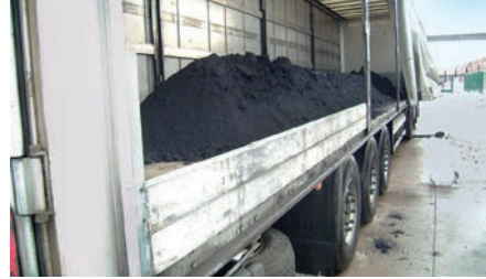
Bild 8.92: So darf lose Schüttung nicht transportiert werden. Der Einsatz von Schüttgutmulden ist notwendig.
